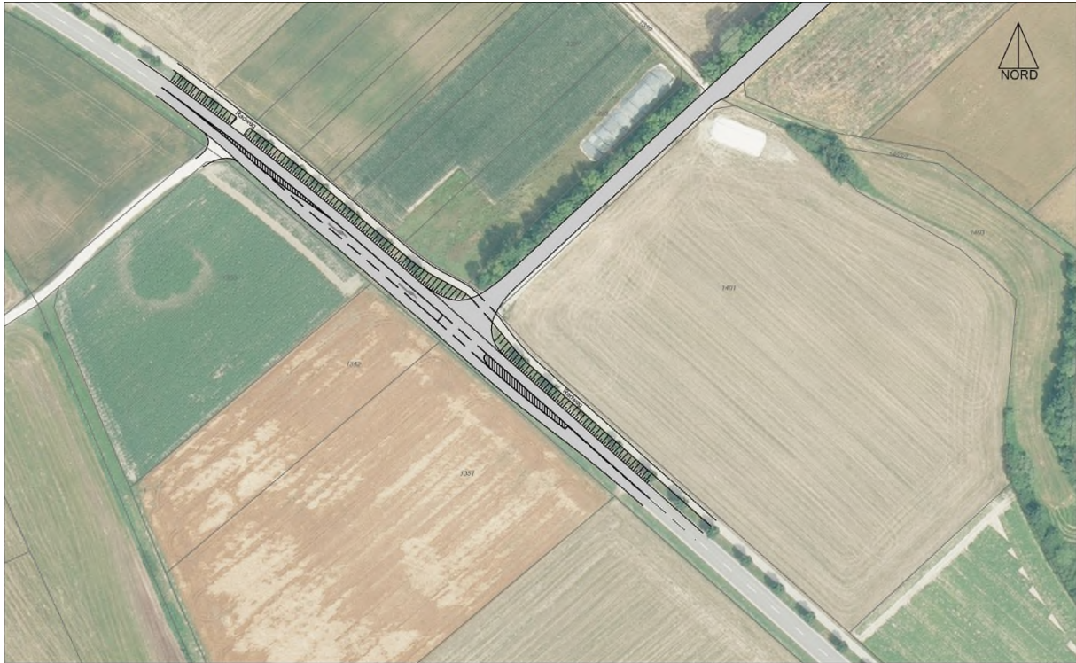
Abbildung: Skizzierung Linksabbieger PAF 34 – außerhalb des Geltungsbereiches © Geobasisdaten: Bayerisches Landesamt für Vermessung und Geoinformation (2011)
